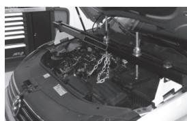
Colocar el soporte motor. Los patines deben colocarse de cada lado del vehículo en una zona resistente.
