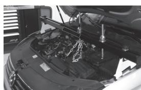
Poser le support moteur. Les patins doivent être placés de chaque côté du véhicule sur une zone résistante.
