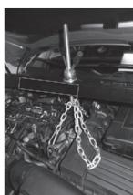
Używać zaczepów mocujących przeznaczonych do przenoszenia silnika.
