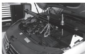
Placer motorstativet. Benene skal placeres i hver sin side af køretøjet på et solidt sted.
