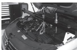
Die Motorbrücke absetzen. Die Abstützböcke müssen auf beiden Seiten des Fahrzeugs auf einem festen Bereich platziert werden.
