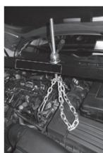
Utilice las anillas de fijación previstas para la manutención del motor.
