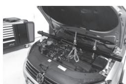
Attacher le moteur en utilisant soit une, soit les deux paires de crochets réglables.
