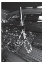
Utilizzare gli anelli di fissaggio per la movimentazione del motore.
