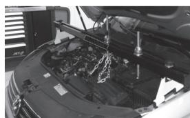
Τοποθετήστε τη βάση στήριξης κινητήρα. Τα πέλματα πρέπει να τοποθετούνται σε κάθε πλευρά του οχήματος επάνω σε ανθεκτική ζώνη.
