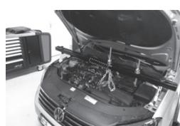
Fijar el motor utilizando uno o dos pares de ganchos ajustables.
