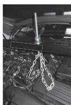
Utilize os anéis de fixação previstos para a manutenção do motor.
