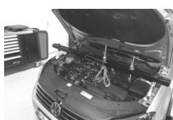
Den Motor mit einem oder mit beiden einstellbaren Hakenpaaren befestigen.
