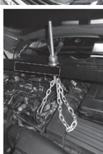
Χρησιμοποιήστε τους προβλεπόμενους κρίκους στερέωσης για τη μεταφορά του κινητήρα.
