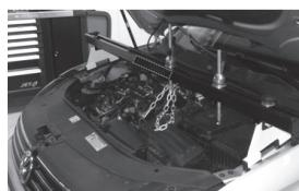
Zamontować wspornik silnika. Podpory należy ustawić po obu stronach pojazdu na wytrzymały podłożu.
