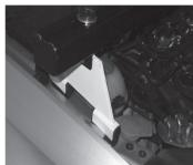
Apretar firmemente las moletas a ambos lados y verificar que son suficientes los pernos de fijación de los patines en la traviesa.
